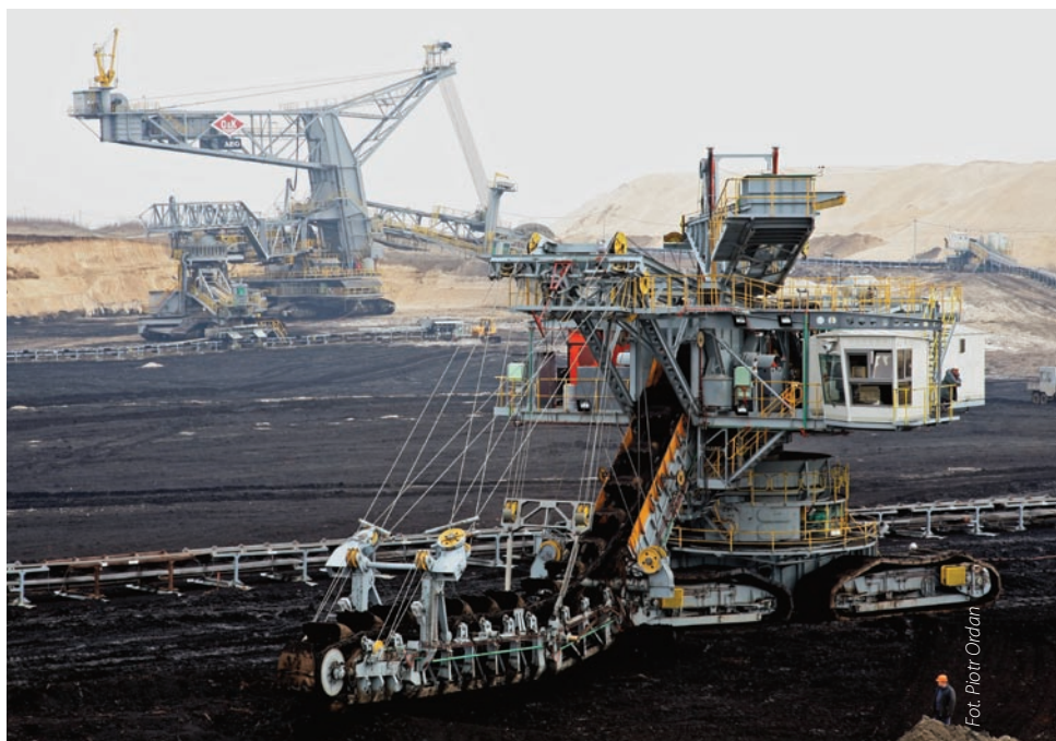
Początek eksploatacji surowca: na pierwszym planie koparka węglowa Rs-400, w głębi koparka nadkładowa SchRs-900.
