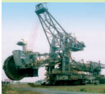
Koparka SchRs-900 w drodze na „Drzewce”. Wysokość maszyny – 39,9 m, długość – 127 m, ciężar całkowity – 2400 ton, prędkość – 8 m/min.
