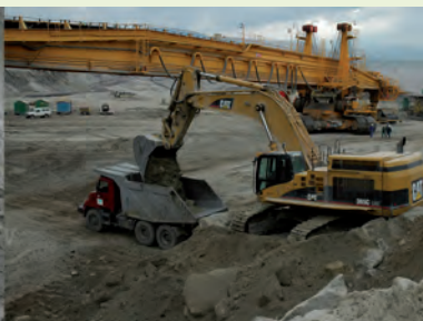
Rys. 15. Otwory strzałowe i transport trudnourabialnych utworów występujących w nadkładzie. Kopalnia Bilina.
