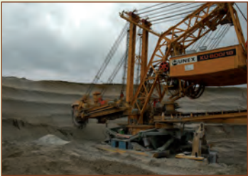
Rys. 11. Koparka KU-800 o wydajności teoretycznej 5.800 m³/h. Kopalnia Bilina.
