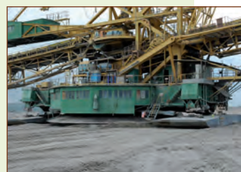
Rys. 20. Podwozie kroczące zwałowarki ZP-6600. Kopalnia Bilina.
