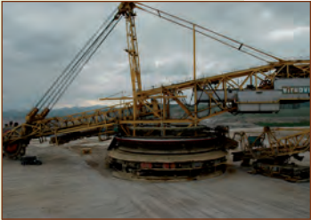
Rys. 7. Koparka K-10000 o wydajności teoretycznej 10.000 m³/h. Kopalnia Bilina (koparka podczas remontu głównego).
