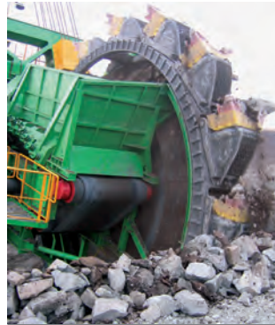
Fot. 3. Koło czerpakowe z czerpakami CK910-N3 przy urabianiu warstw zbliżonych do pokazanych na fot. 1.
