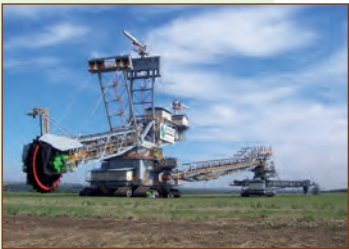
Rys. 10. Najnowsza koparka SchRs-1320 oddana do eksploatacji w 2005 r. Kopalnia Libouš.
