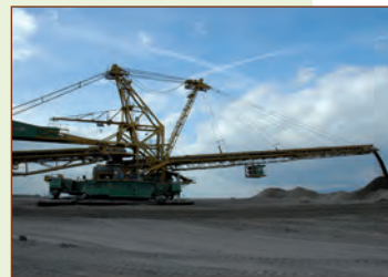
Rys. 19. Zwałowarka na podwoziu kroczącym ZP-6600. Kopalnia Bilina.
