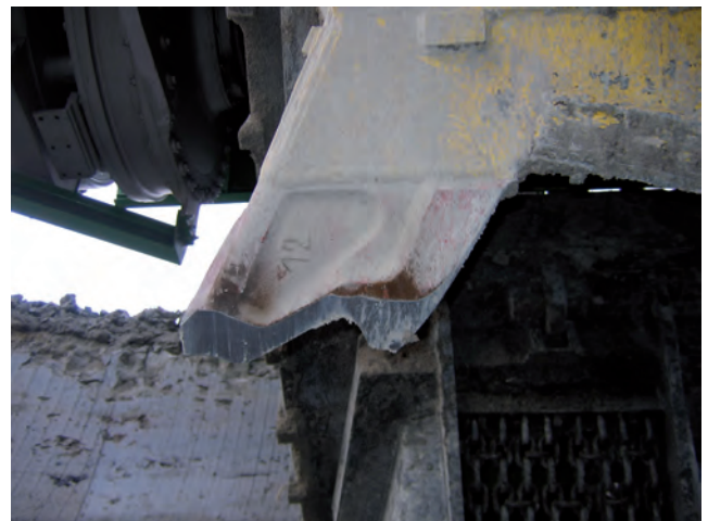
Fot. 4. Zużycie naroży czerpaków CK910-N3 – po ca 136 h pracy w warunkach trudnourabialnych.
