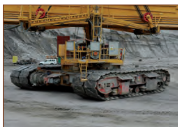
Rys. 13. Podwozie z podwójnymi gąsienicami w podawarce koparki KU-800. Kopalnia Bilina.
