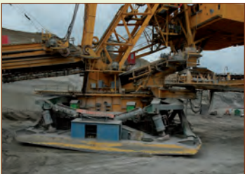
Rys. 12. Podwozie kroczące koparki KU-800. Kopalnia Bilina.
