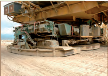
Rys. 9. Podwozie kroczące podawarki współpracującej z koparką K-10000. Kopalnia Bilina.
