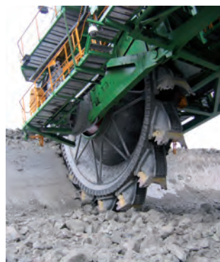
Fot. 1. Czerpaki CK910-N3 w procesie urabiania po ca 104 h pracy.
