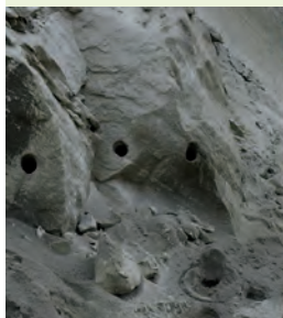
Rys. 15. Otwory strzałowe i transport trudnourabialnych utworów występujących w nadkładzie. Kopalnia Bilina.
