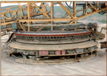
Rys. 8. Podwozie kroczące i obrotnica koparki K-10000. Kopalnia Bilina.
