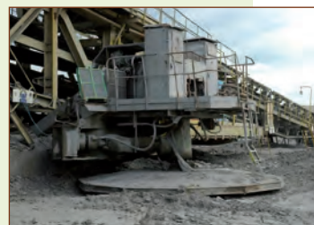
Rys. 18. Podwozie kroczące stacji napędowej. Kopalnia Bilina.
