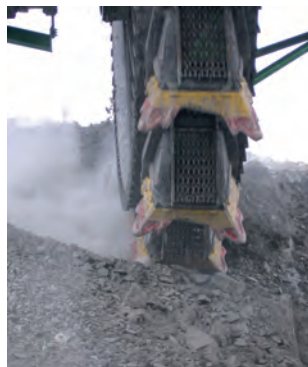
Fot. 2. Czerpaki CK910-N3 w procesie urabiania bardzo trudnourabialnych frakcji o cechach zbliżonych do zbitego rumoszu. W czasie ich urabiania wydziela się charakterystyczny dym.
