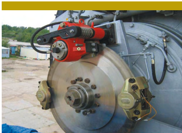
Sprzęgło przeciążeniowe szybko odcinające nadwyżki dynamiczne procesu urabiania (odkryte).
