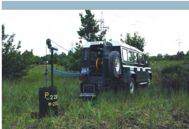
Paramex – kontrola piezometrów.
