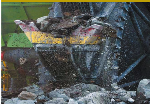
Czerpaki z narożami odlewanymi głębokohartowanymi (staliwo stopowe).
