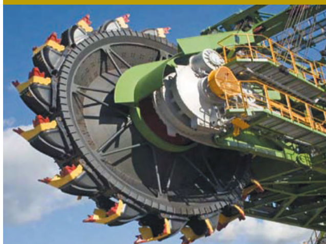
Układ urabiania z zespołem napędowym 2x500 kW.
