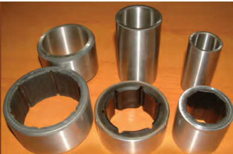
Rys. 7. Promieniowe łożyskowanie ślizgowe pompy.
