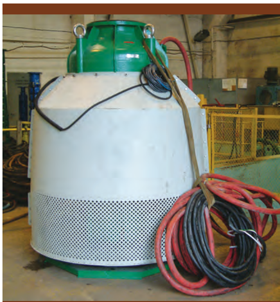
Rys. 20. Pompa OZ z płaszczem chłodzącym
