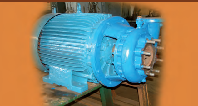
Rys. 17. Pompa monoblokowa typu PJM.
