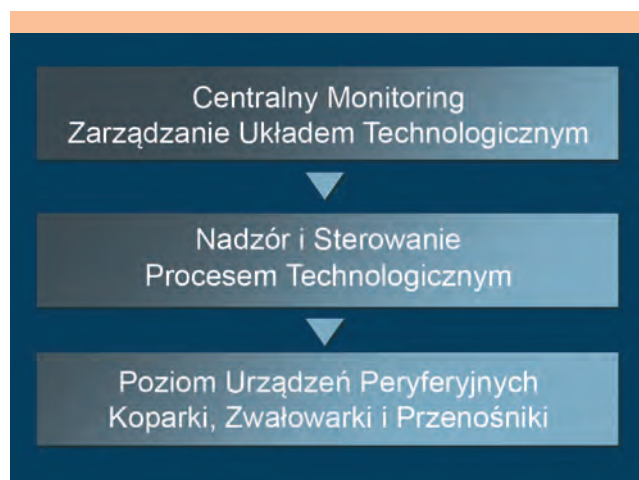
Rys. 3. Struktura zarządzania układem technologicznym w Kopalni Turów.
