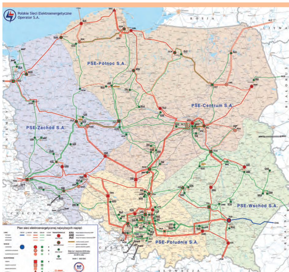
Rys. 3. Stan krajowych linii wysokich napięć.
