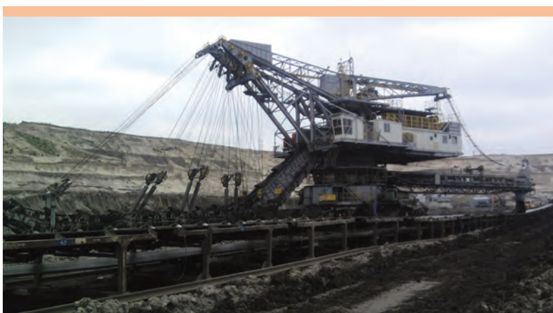
Koparka Rs-560 podczas „czyszczenia” stropu węgla.
