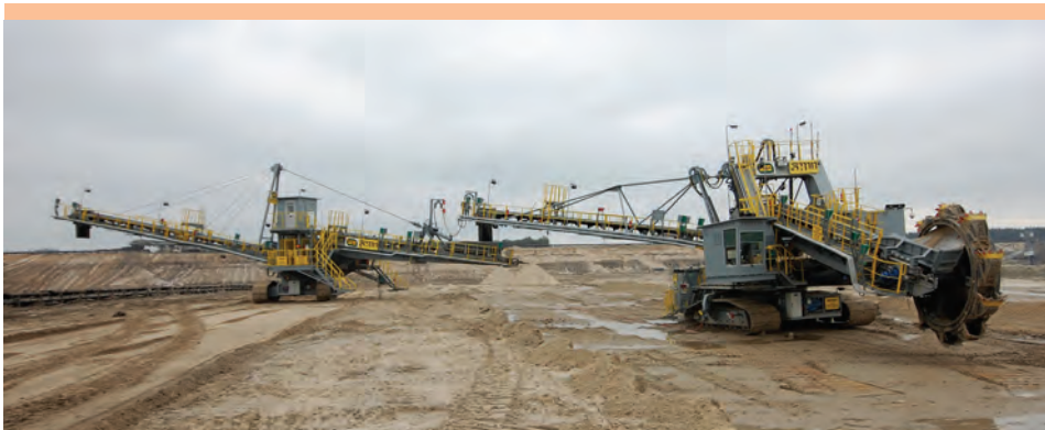
Nowy nabytek w umaszynowaniu KWB „Konin” – koparka KWK-250L wraz z samojezdnym przenośnikiem PGOT 1250.38 na odkrywce „Tomisławice”.
