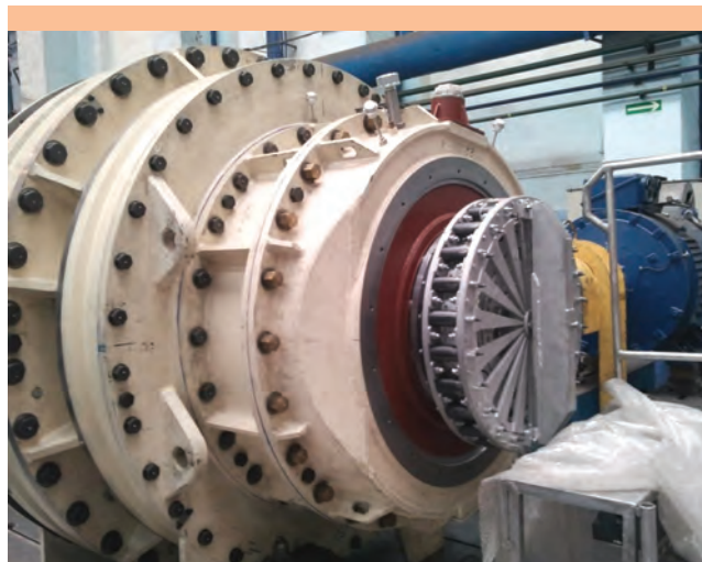
Rys. 2. Sprzęgło przeciążeniowe na przekładni podczas prób stanowiskowych.
