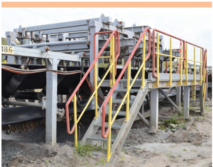
Fot. 2. Człon pomiarowy do badań mikro na przenośniku Z-12.
