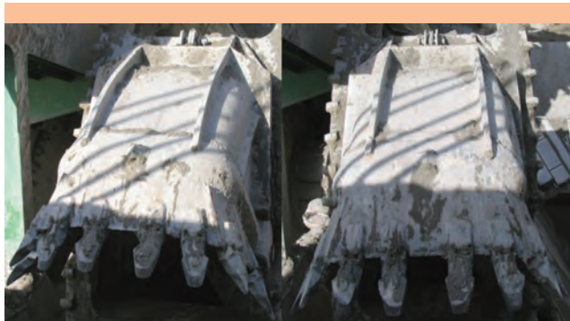
Rys. 2c. Czerpak R12. E8 system mocowania SUPER V – podczas prób eksploatacyjnych.
