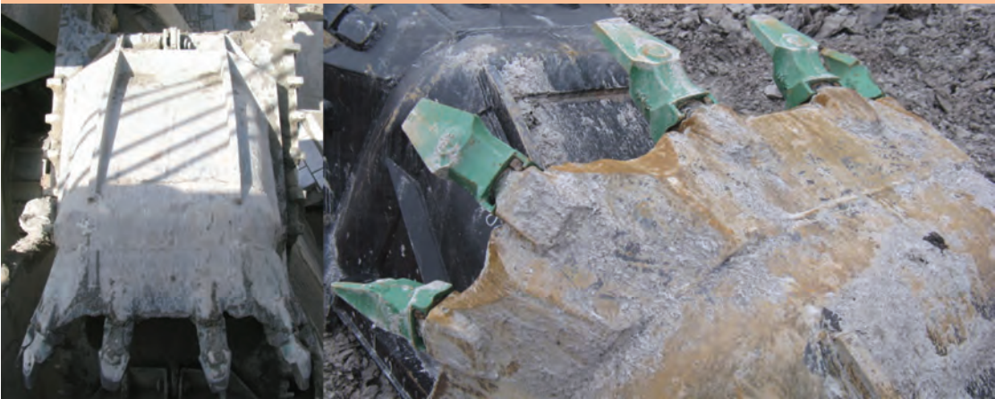
Rys. 1c. Czerpak R12. E – zużycie zębów i noża czerpaków.
