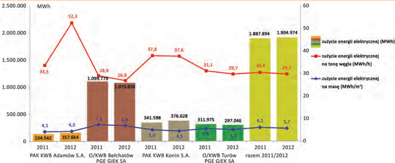
Rys. 4. Zużycie energii elektrycznej oraz wskaźniki energochłonności w poszczególnych kopalniach węgla brunatnego za 12 miesięcy w latach 2011-2012.
