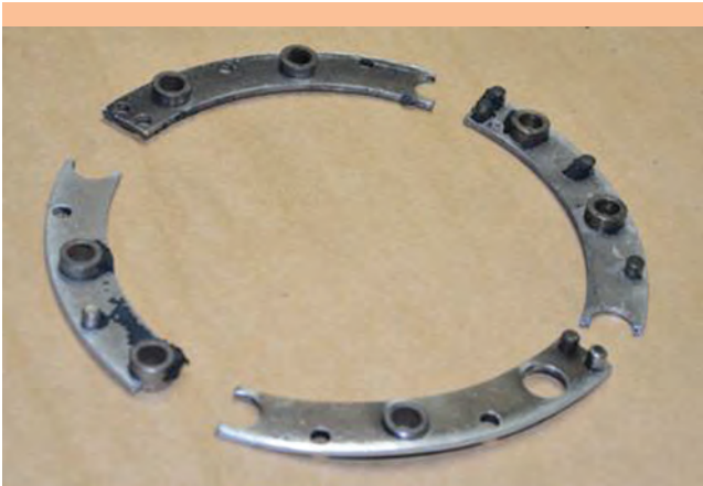
Zniszczone przekładki przed modernizacją.
