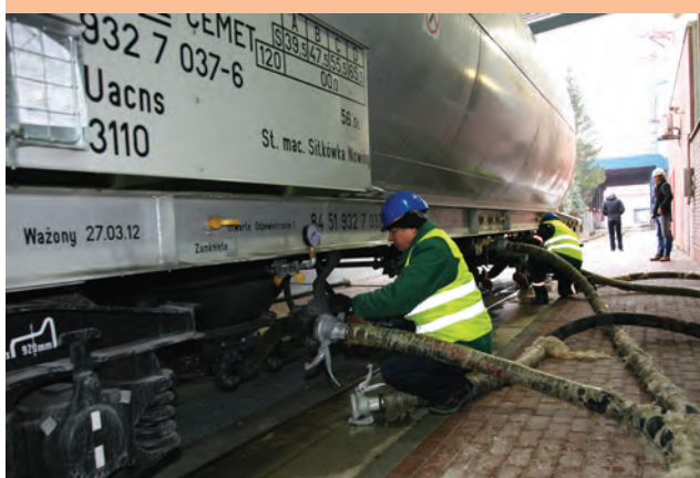
Obsługa instalacji rozładunkowej cysterny z mączką kamienia wapiennego.
