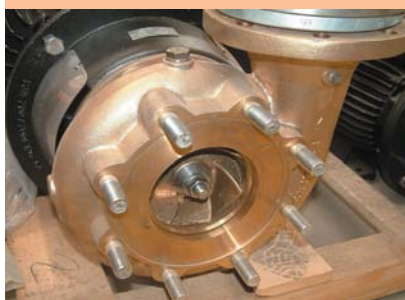
Fot. 6. Pompy monoblokowe typu PJM wykonane z brązu.
