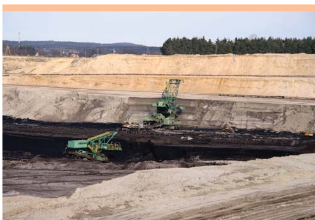
Zaleganie węgla i struktura nadkładu odkrywki „Władysławów”.
