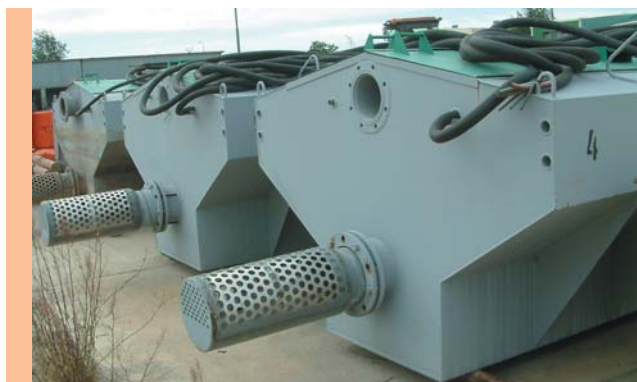
Fot. 8. Ponton z rurą ssącą wysuniętą poza obrys pontonu.
