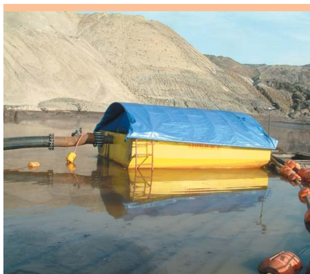
Fot. 27. Ponton z zespołem pompowym do hydrotransportu PH-250/1460-570.
