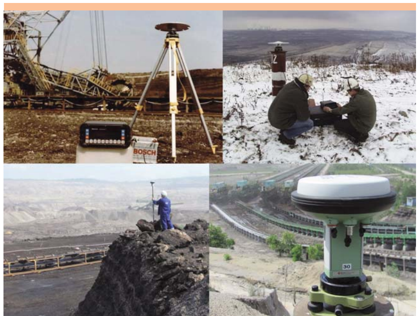
Odbiorniki GPS: powyżej starszego typu, poniżej obecnie stosowane.
