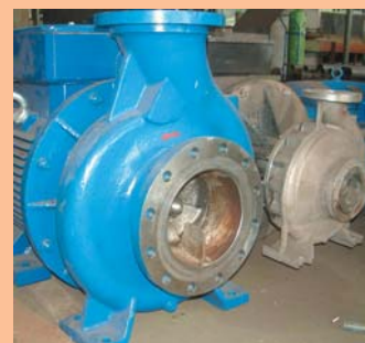
Fot. 6. Pompy monoblokowe typu PJM wykonane z brązu.
