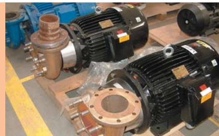
Fot. 3. Pompy monoblokowe typu PJM.
