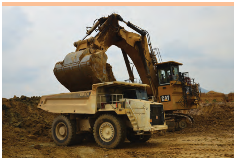
Rys. 9. Koparka CAT6040 współpracująca z wozidłem Terex TR 100 pracujące w kopalni South Field.
