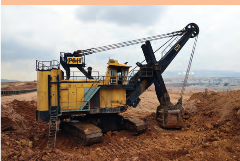
Rys. 4. Koparka P&H BLE 2100 o pojemności łyżki 15 m³ pracująca w kopalni South Field.
