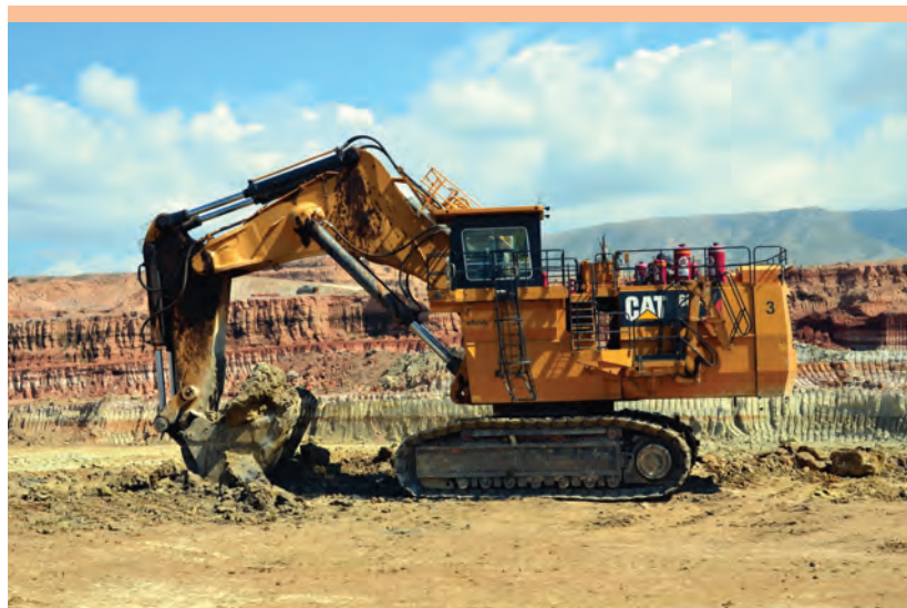
Rys. 6. Koparka CAT 6040 o pojemności łyżki 22 m 3 pracująca w kopalni South Field.
