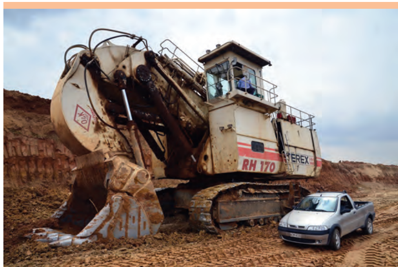
Rys. 5. Koparka O&K-RH170 o pojemności łyżki 21 m 3 pracująca w kopalni South Field.
