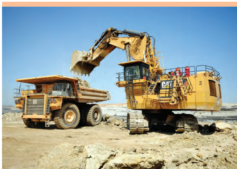
Rys. 8. Koparka CAT6040 współpracująca z wozidłem Hitachi EH3500 pracujące w kopalni South Field.
