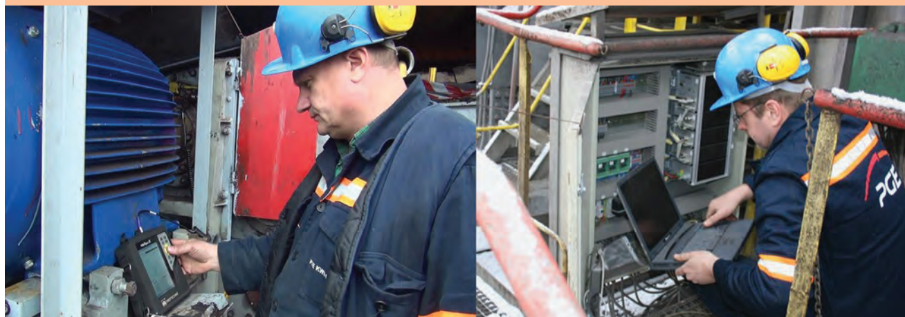
Zbieranie danych do analizy drganiowej silnika napędu jazdy koparki K-73 i ściąganie danych z monitoringu koparki K-41.
