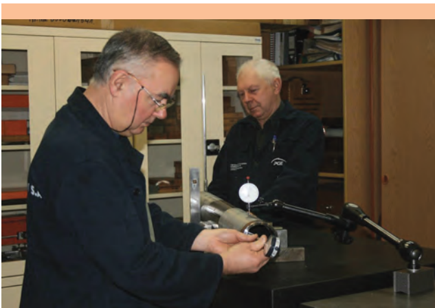
Pomiar geometrii płaszcza krążnika.
