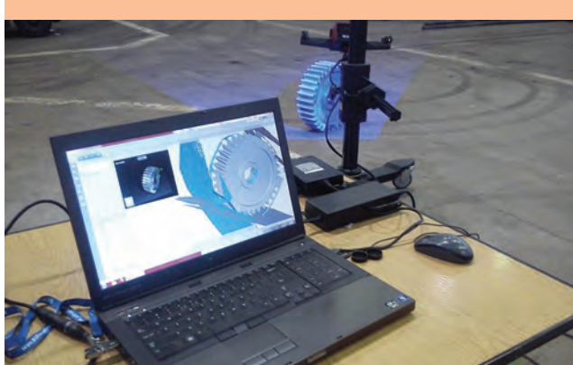
Skanowanie wykonywane w celu analizy stopnia zużycia koła zębatego.
