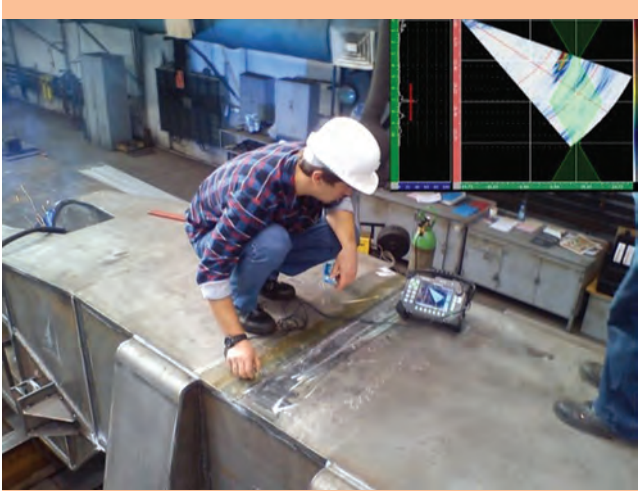
Badanie defektoskopowe spoin z wykorzystaniem defektoskopu Epoch 1000.
