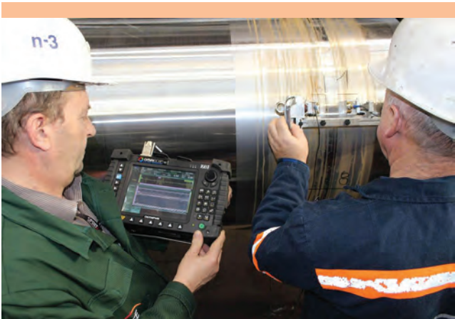
Pomiar spoin obwodowych bębna φ800 mm z wykorzystaniem defektoskopu OMNISCAN MX ze skanerem do badań TOFD z układem głowic.
