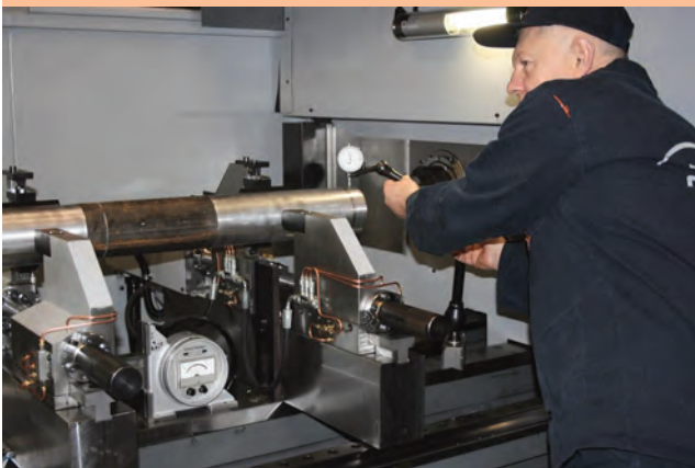
Pomiar geometrii nakiełczarki – obrabiarki sterowanej numerycznie.
