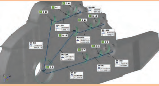
Pomiar rozstawu osi – wizualizacja.
