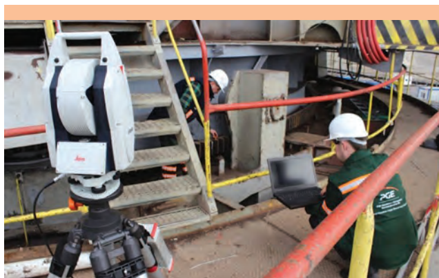
Pomiar kołowości wieńca zębatego.
