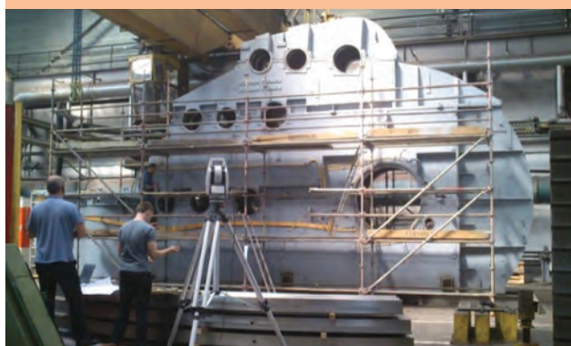
Pomiar korpusu przekładni głównej napędu koła czepakowego.
