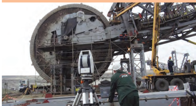
Pomiar położenia ściany wewnętrznej głowicy koła czepakowego.
