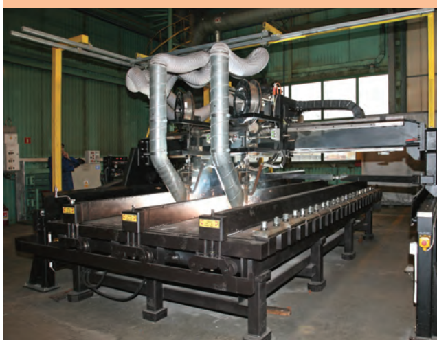
Stanowisko do napawania wykładzin trudnościeralnych.
