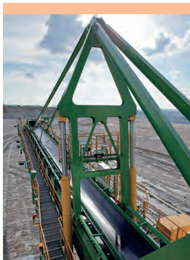
Rys. 3. Układ zwodzenia wysięgnika załadowniczego z wykorzystaniem siłowników hydraulicznych.
