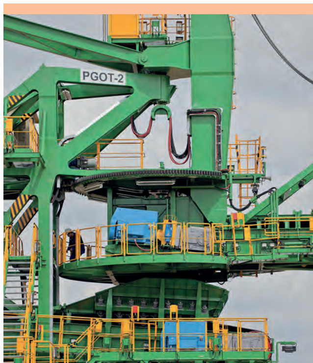
Rys. 4. Zawieszenie części odbierającej na konstrukcji nośnej nadwozia.
