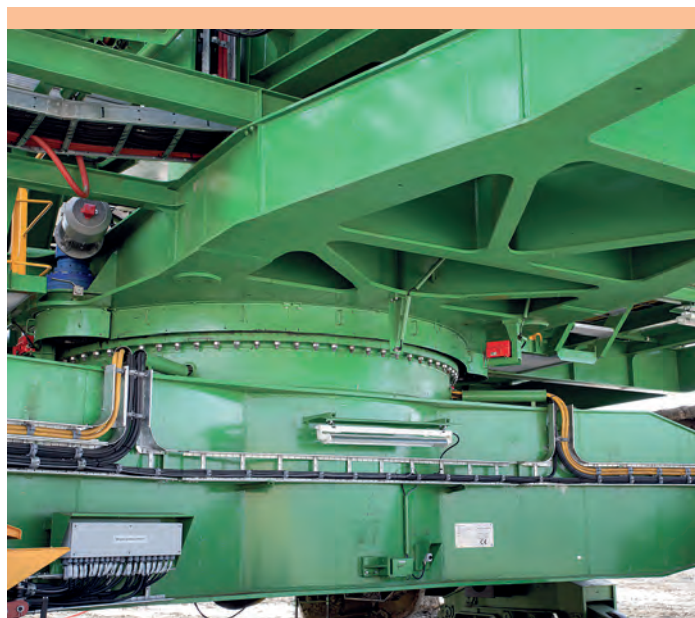
Rys. 5. Posadowienie konstrukcji nośnej nadwozia na podwoziu poprzez łożysko momentowe.
