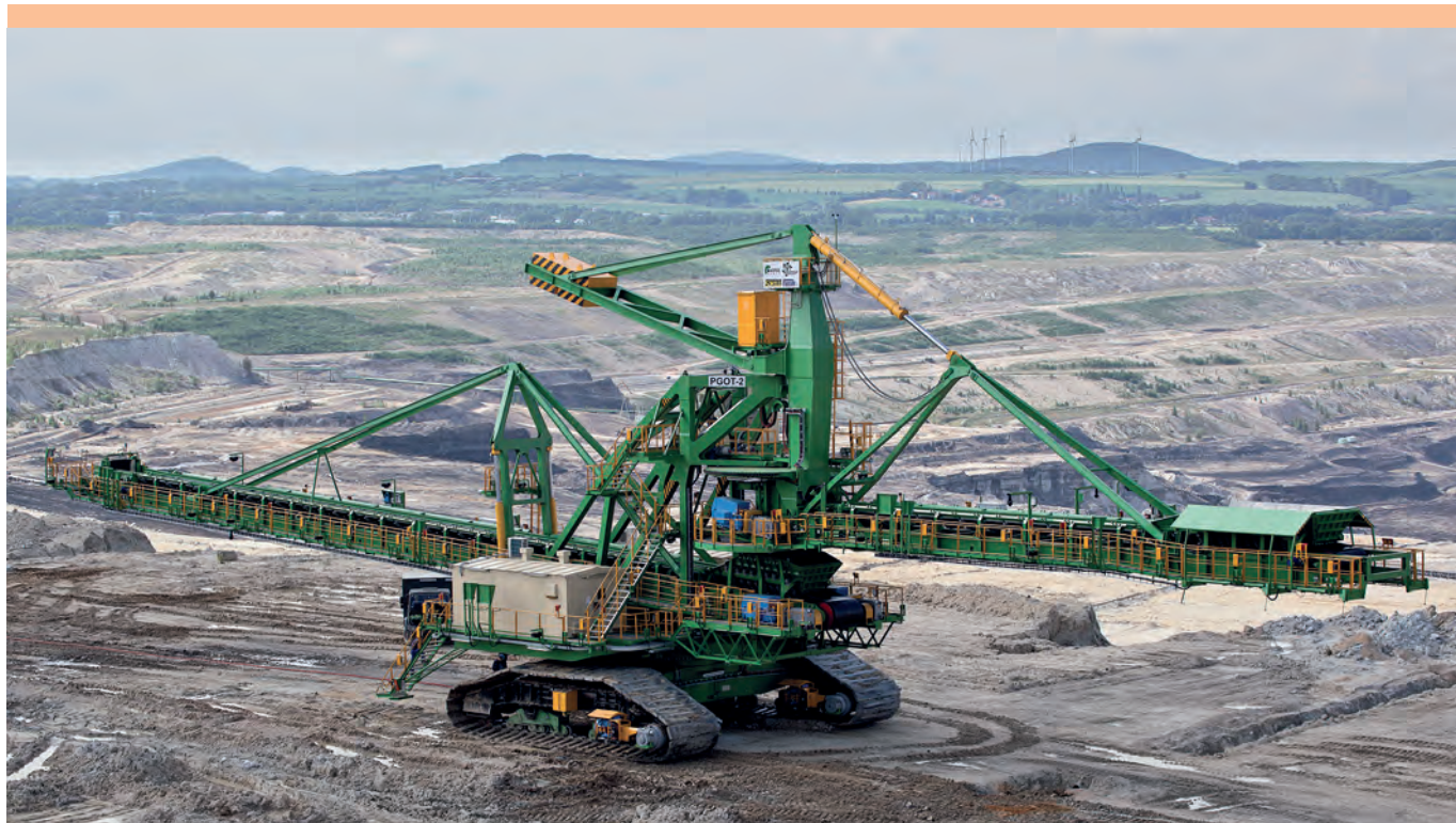
Rys. 8. Przenośnik PGOT-4500.70 w trakcie transportu na poziomie roboczym.
