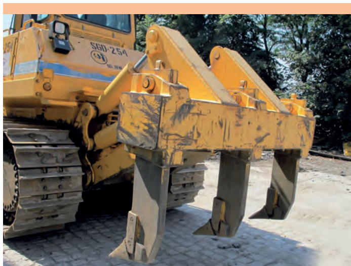
Rys. 2. Spycharka wyposażona w osprzęt zrywający, wykorzystywana do wspomaganie pracy koparki niedostosowanej do urabiania przerostów skał twardych.
