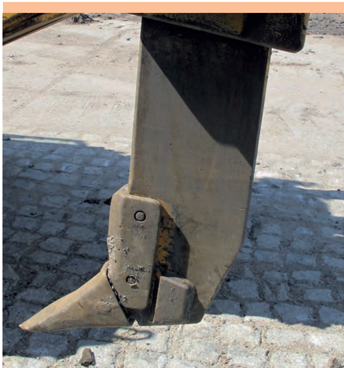
Rys. 11. Ząb z grotem możliwy do zaadaptowania w zrywaku koparkowym.
