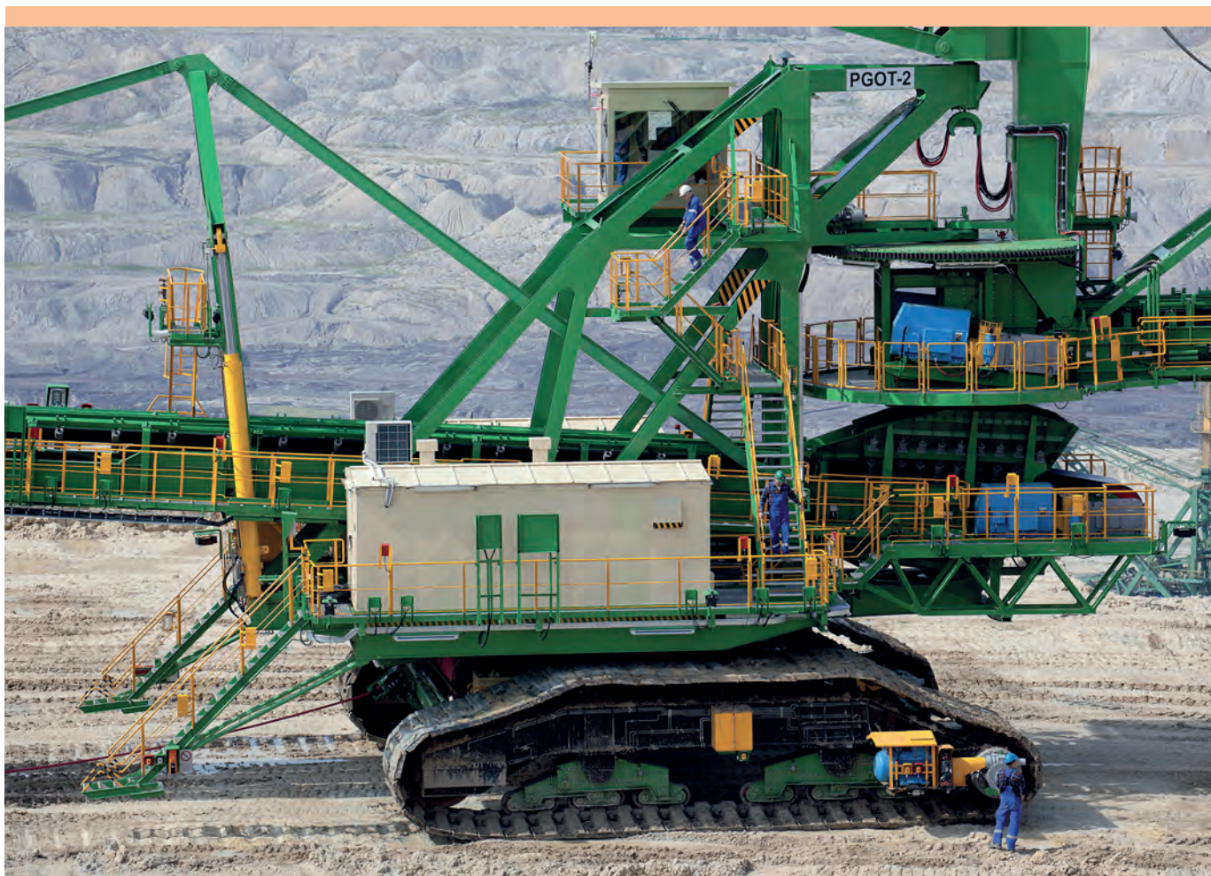
Rys. 7. Układ komunikacyjny w środkowej części maszyny.
