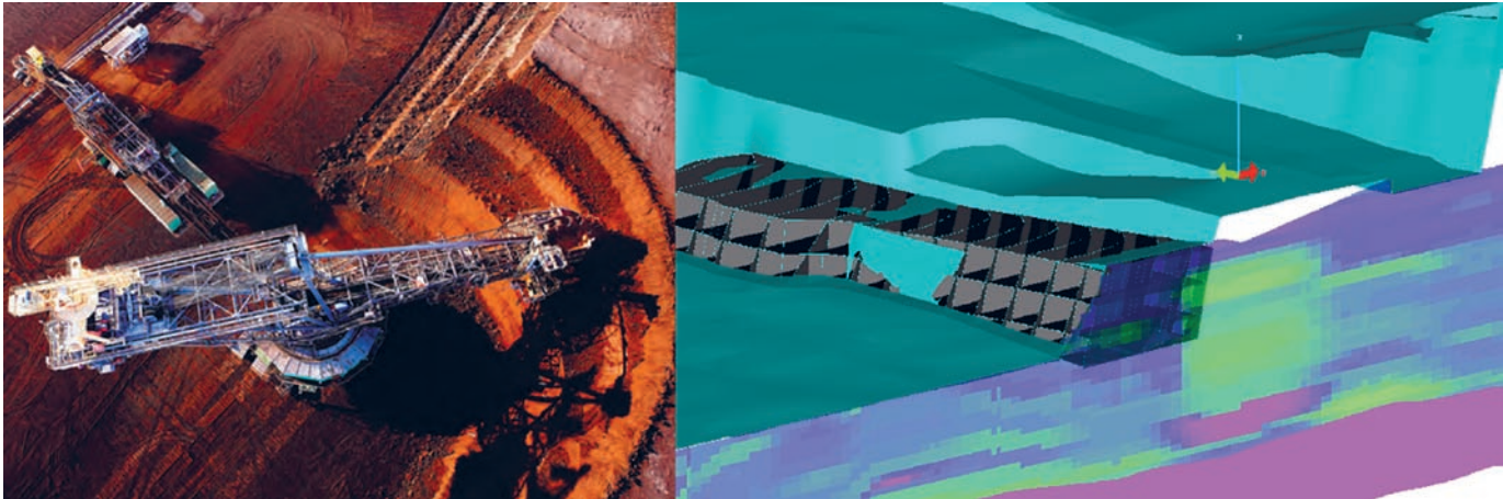
Rys. 5. Przykładowy podział projektu zabierki na bloki (bryły 3D) lepiej odzwierciedlające faktyczny sposób urabiania tarasów zabierki [opracowanie własne].
