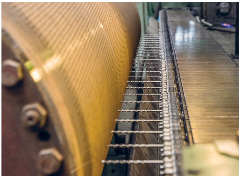
BESTGUM POLSKA posiada jedyną w kraju wiertarkę wielowrzecionową do owiercania wałów papierniczych.
